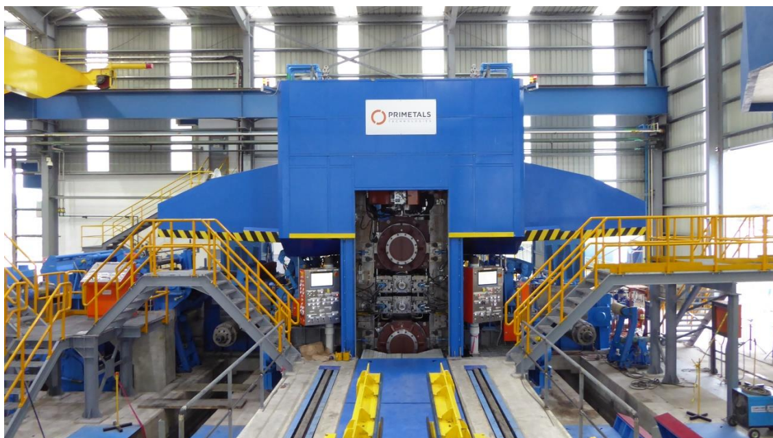
プライメタルズテクノロジーズがメキシコの Tyasa 社に納入した 4 段可逆式冷間圧延機
