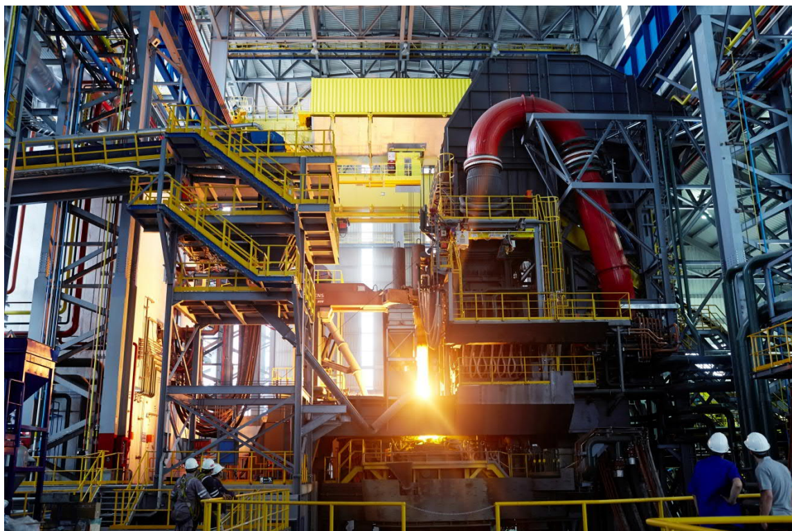
Elektrolichtbogenofen EAF Quantum von Primetals Technologies
