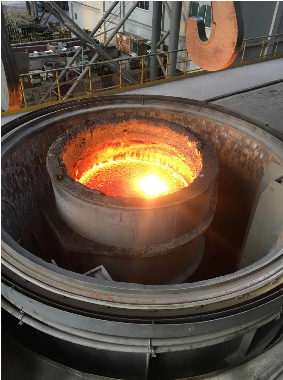
Vakuumentgasungsanlage (VD-Anlage) von Primetals Technologies
