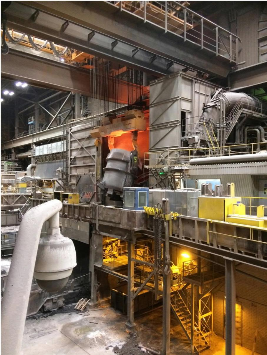
Von Primetals Technologies modernisierter AOD-Konverter am Standort Tornio, Finnland, von Outokumpu Stainless Oy.
