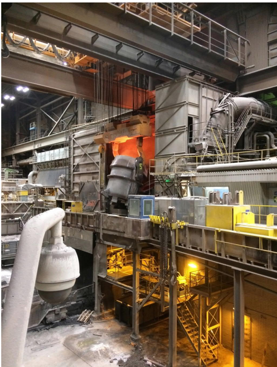
Модернизированный Primetals Technologies конвертер AOD на заводе Оутокумпу в Торнио (Финляндия)
