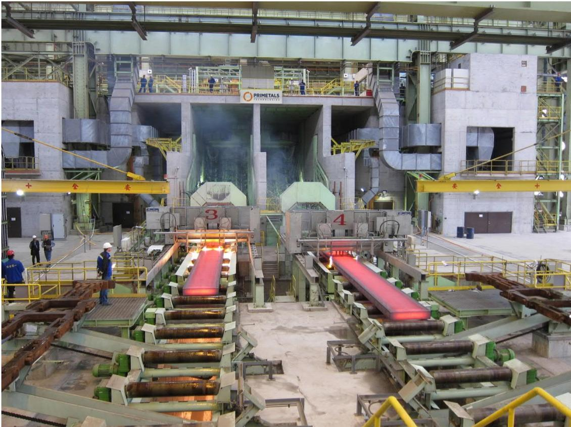
プライメタルズテクノロジー製の2ストランド（条）式スラブ連続 casting 機
