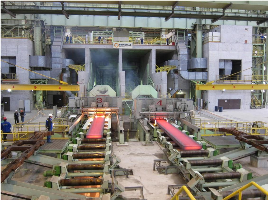
Máquina de lingotamento contínuo de dois veios de placas da Primetals Technologies.
