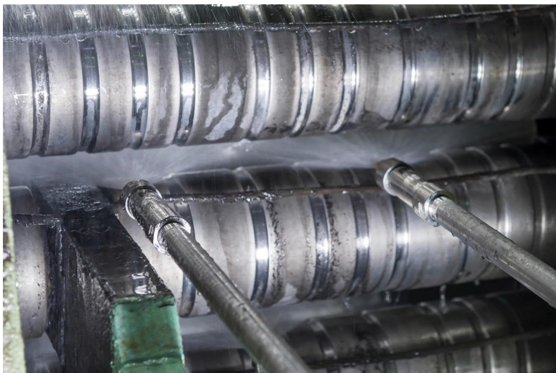
普锐特冶金技术公司安装在弯曲段的 DynaJet Flex 脉冲宽度冷却控制系统
