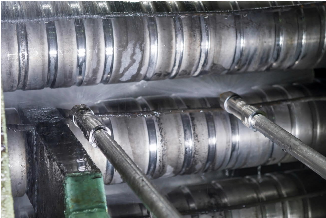
Im Biegemaschinenbereich montiertes DynaJet Flex-Kühlsystem mit Pulsweitenmodulation von Primetals Technologies
