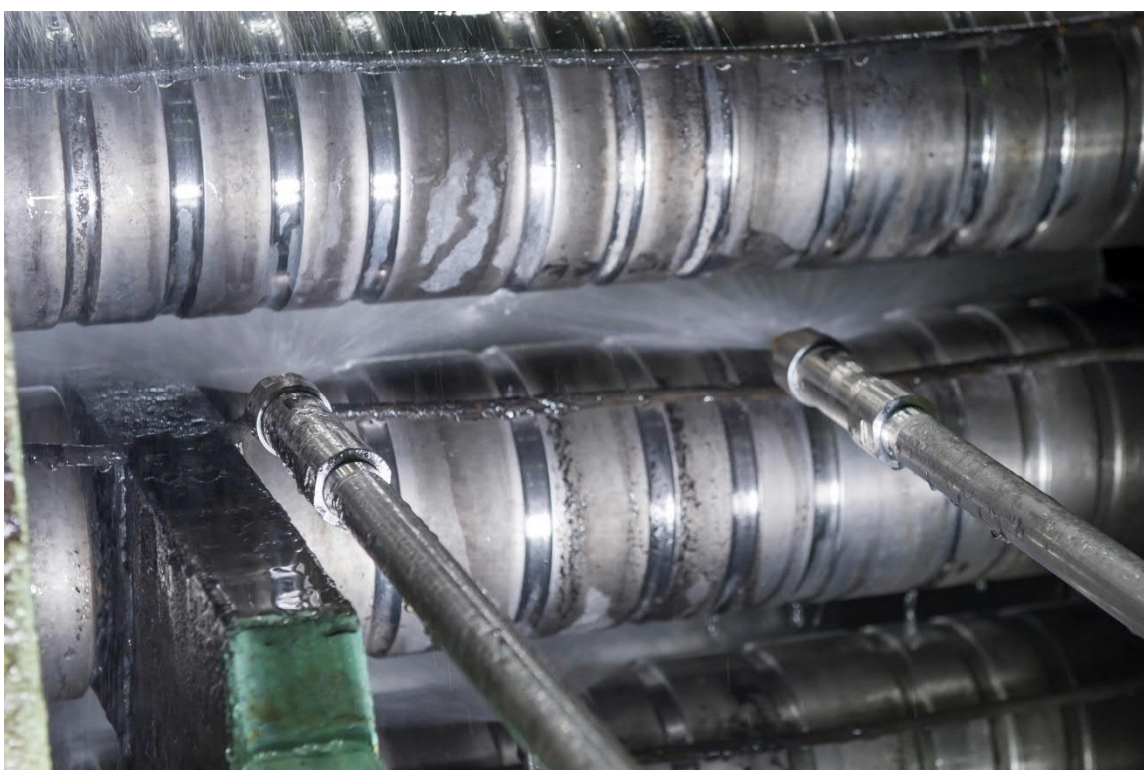
Sistema DynaJet Flex de resfriamento pulsante da Primetals Technologies instalado na zona do molde curvo.
