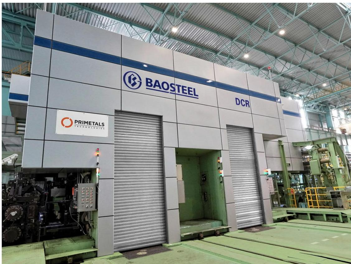
Vorderansicht des neuen zweigerüstigen Kaltwalzwerks von Primetals Technologies
