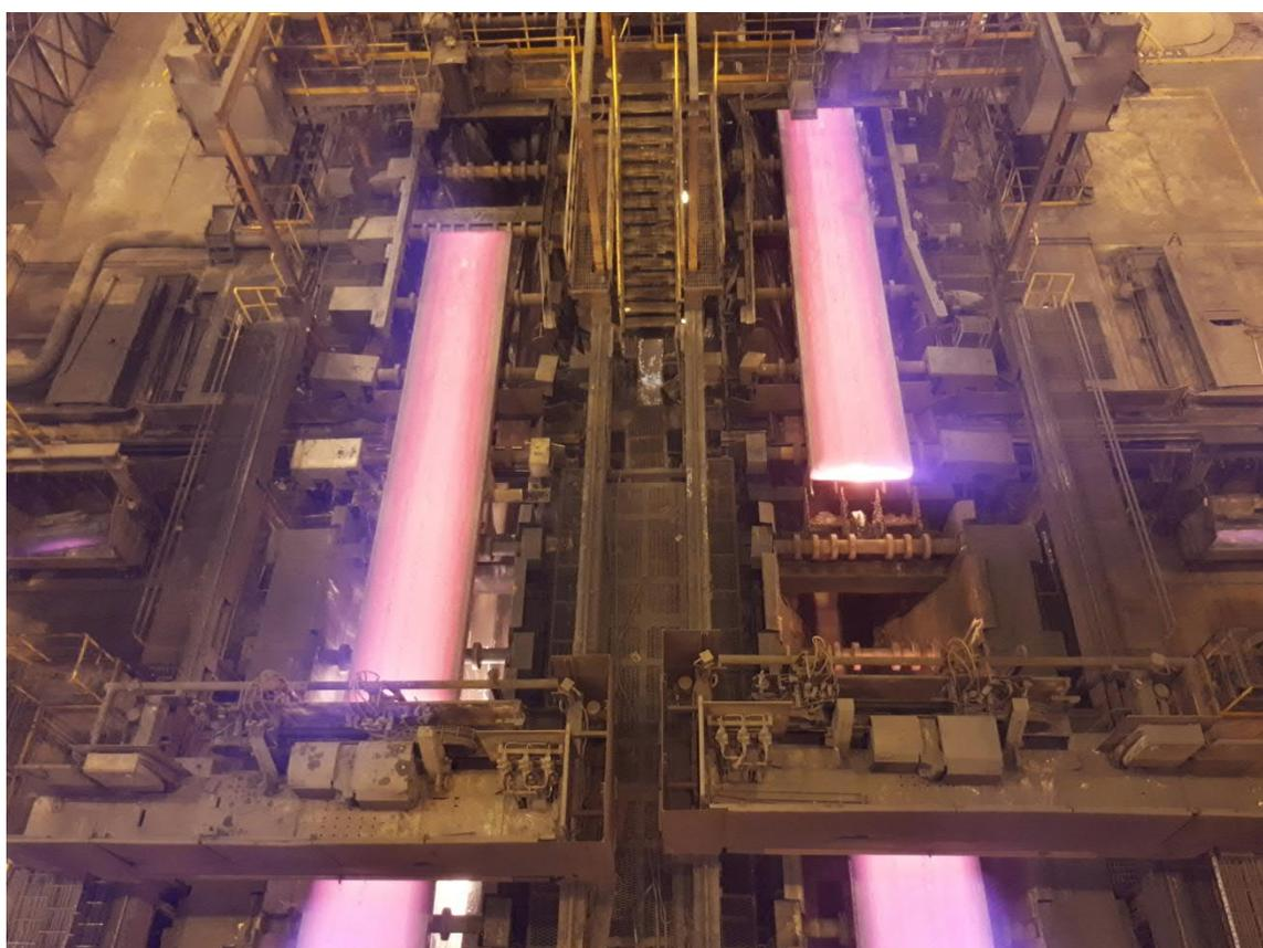
プライメタルズテクノロジーズがアップグレードを担当した、台湾の鉄鋼メーカー CSC の高雄製鉄所にあるスラブ連続鑄造機 6 号機。
