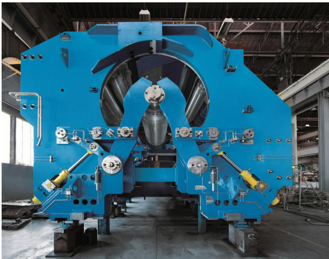
厚板および高張力鋼板の巻き取りが可能なプライメタルズテクノロジー製のパワーコイラー
