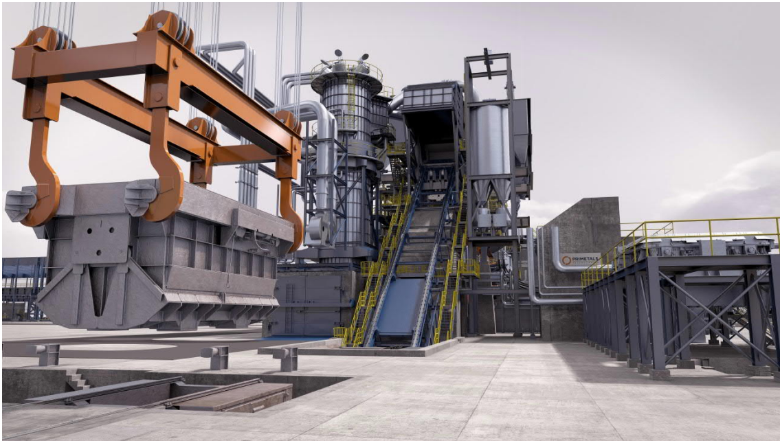
普锐特冶金技术 Quantum 电弧炉的计算机三维效果图
