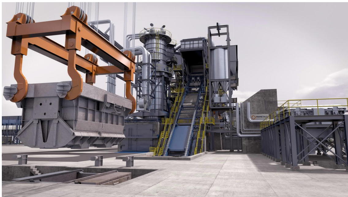
Imagem 3D animada por computador do forno elétrico a arco Quantum da Primetals Technologies
