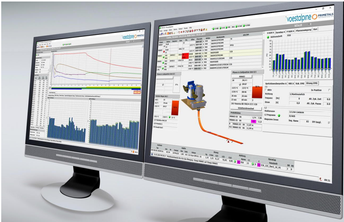
普锐特冶金技术为奥地利奥钢联钢铁公司林茨厂 8 号板坯连铸机提供的新 2 级系统的 HMI 画面 (照片: © iStock.com/Eraxion)
