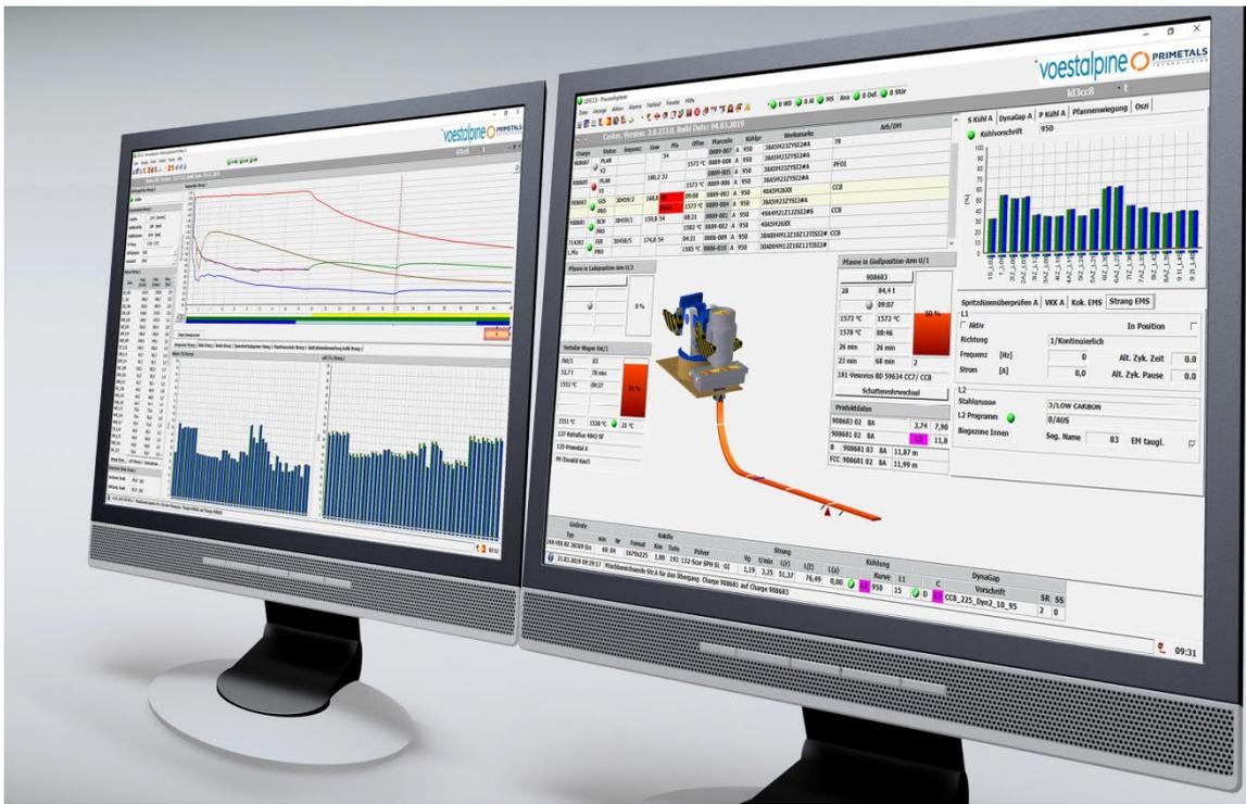
プライメタルズテクノロジーズが納入した、オーストリアにあるフェストアルピーネ社リンツ製鉄所のスラブ連続鋳造機 8 号機向け新レベル 2 システムのヒューマンマシンインターフェース（HMI）（写真：© iStock.com/Eraxion）
