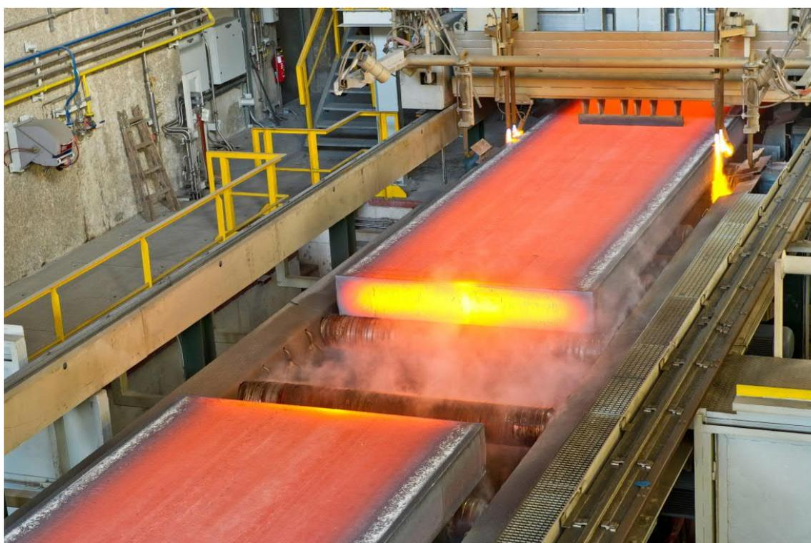
Máquina de lingotamento contínuo de um veio da Primetals Technologies
