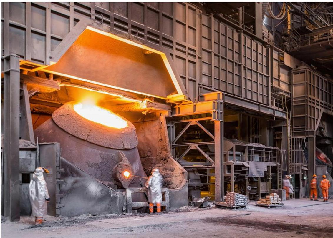
Convertedor BOF na aciaria da HBIS Group Serbia Iron & Steel LLC (HBIS Serbia) em Smederevo, Sérvia. A Primetals Technologies substituirá o convertedor BOF nº 2 (imagem por cortesia da HBIS).
