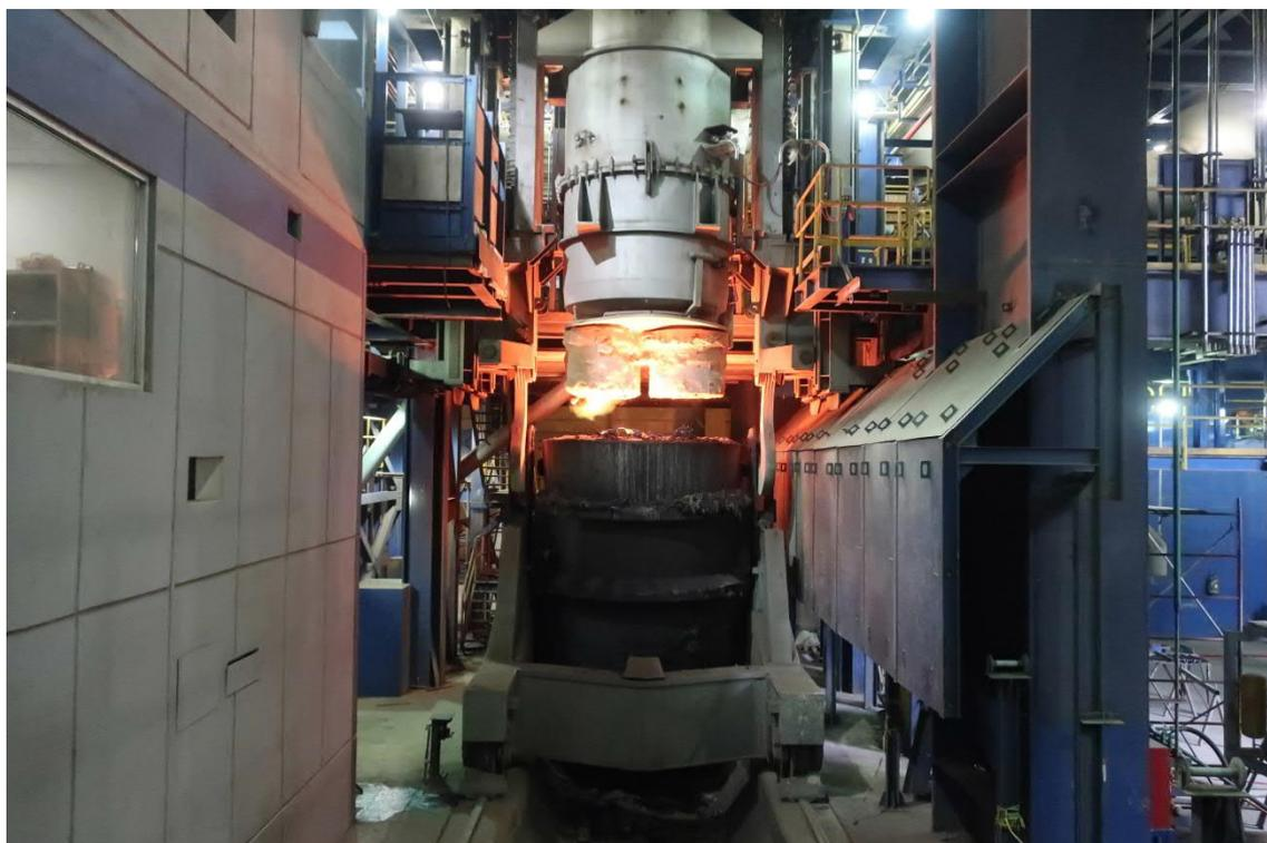
Altos Hornos de Mexico (AHMSA)墨西哥 Monclova 厂第二转炉炼钢车间安装的普锐特冶金技术 RH 真空脱气设备
