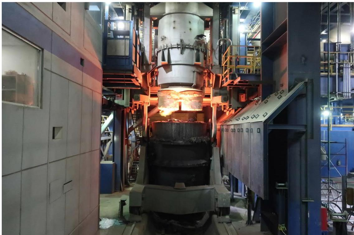
RH-Vakuumentgasungsanlage von Primetals Technologies im Konverterstahlwerk 2 bei Altos Hornos de México (AHMSA) in Monclova, Mexiko
