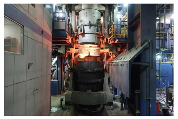
Planta de desgaseificação a vácuo RH da Primetals Technologies instalada no convertedor da Aciaria nº 2 da Altos Hornos de Mexico (AHMSA) em Monclova, México
