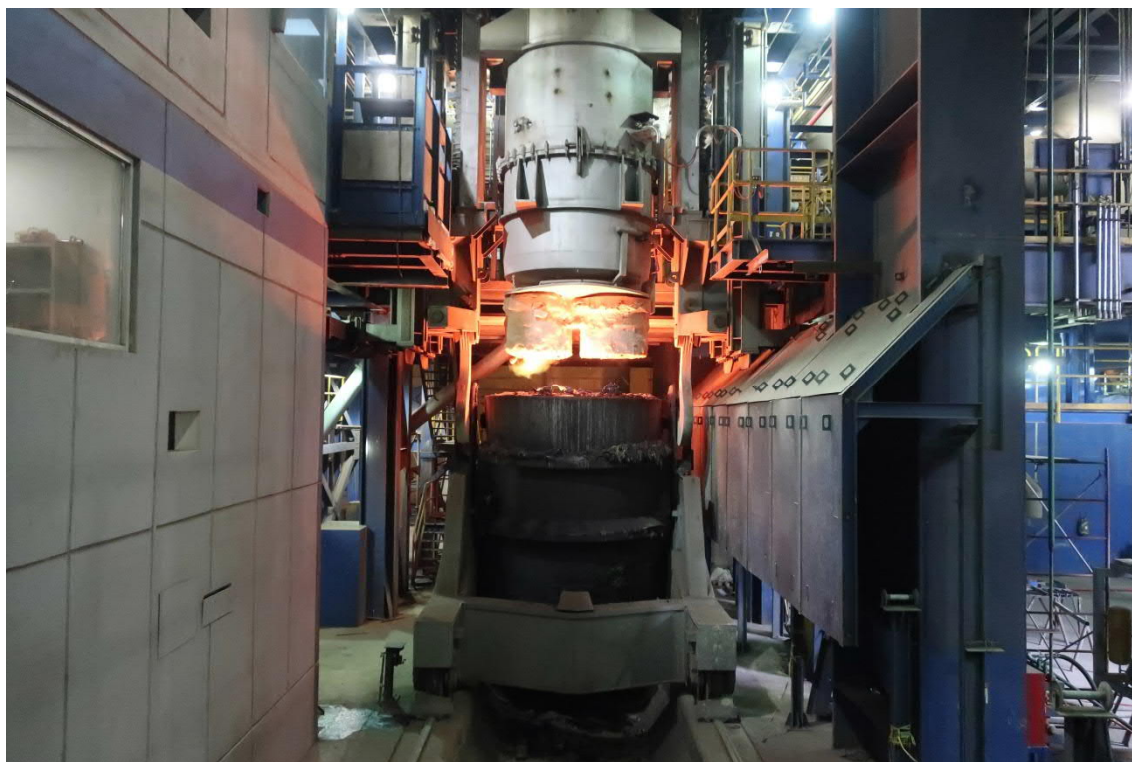
Установка циркуляционного вакуумирования стали от Primetals Technologies, установленная в конвертерном цехе № 2 на металлургическом комбинате Altos Hornos de Mexico (AHMSA) в городе Монклова, Мексика
