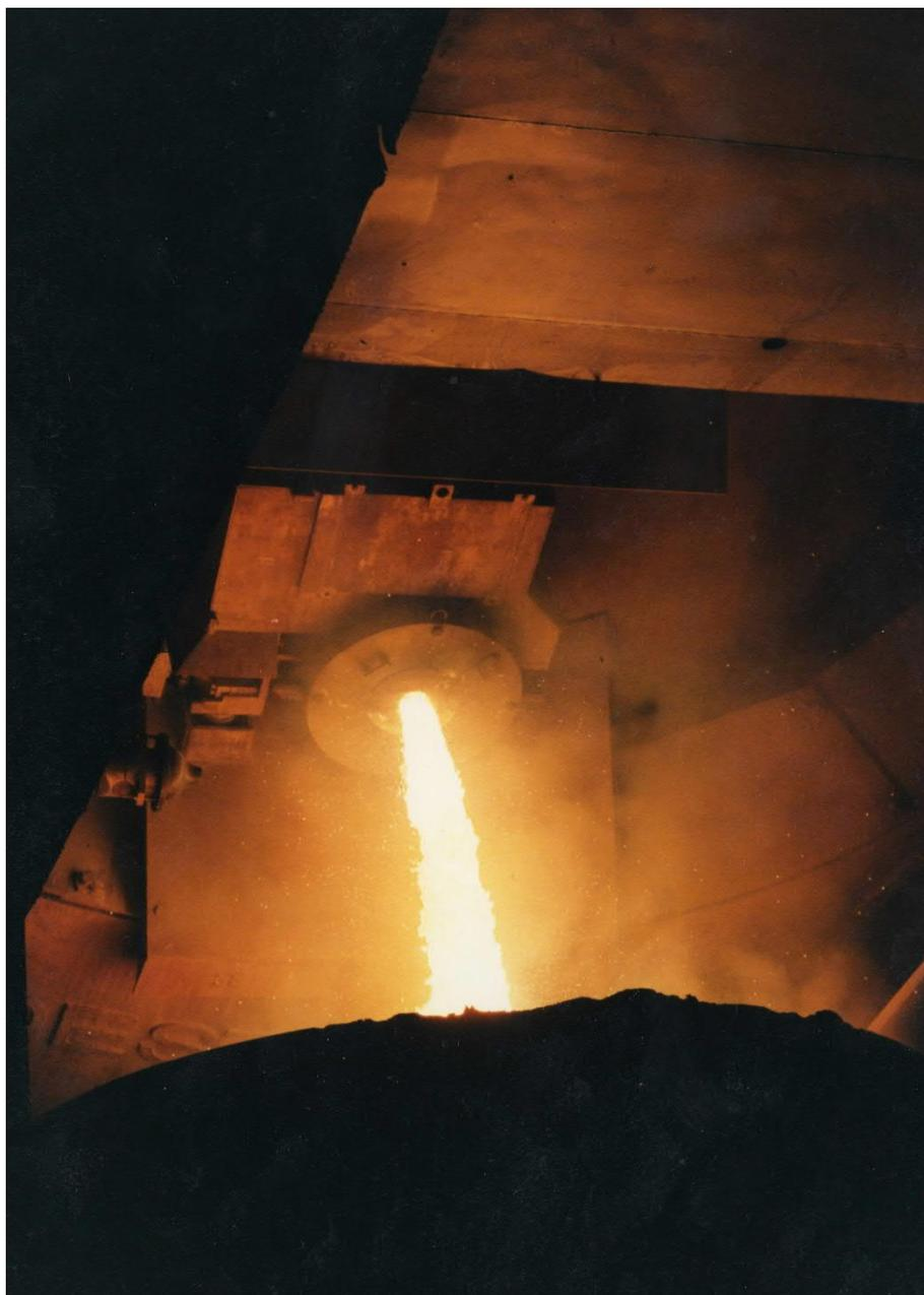
BOF 转炉正在出钢。普锐特冶金技术新开发的自动出钢系统提高了工作效率和安全水平。该系统将在江苏沙钢的张家港钢厂首次投入商业化应用。
