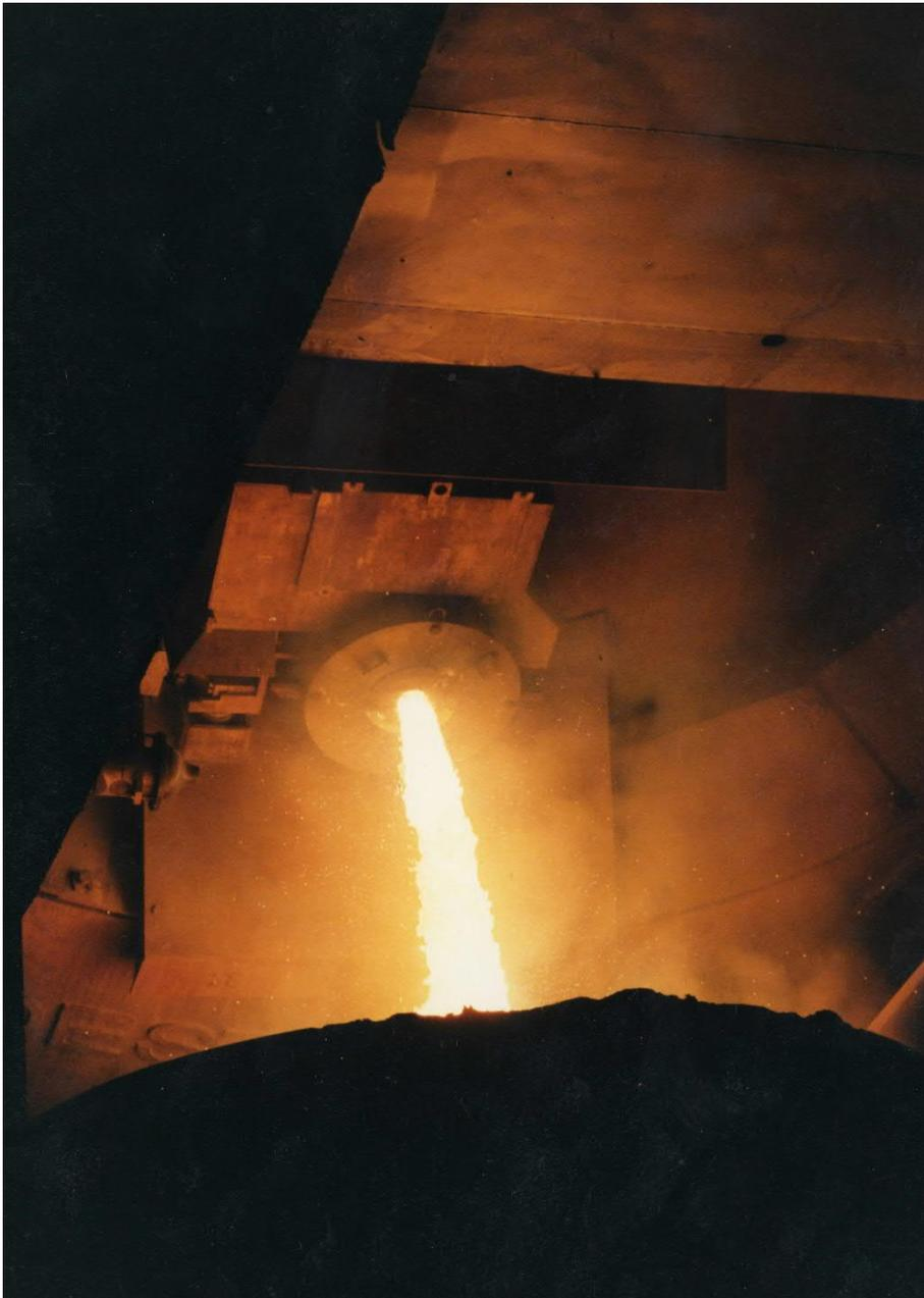
Abstich eines BOF-Konverters. Das neuentwickelte automatische Abstichsystem von Primetals Technologies verbessert Produktivität und Arbeitssicherheit: Erste kommerzielle Referenz bei Jiangsu Shagang im Stahlwerk Zhangjiagang.
