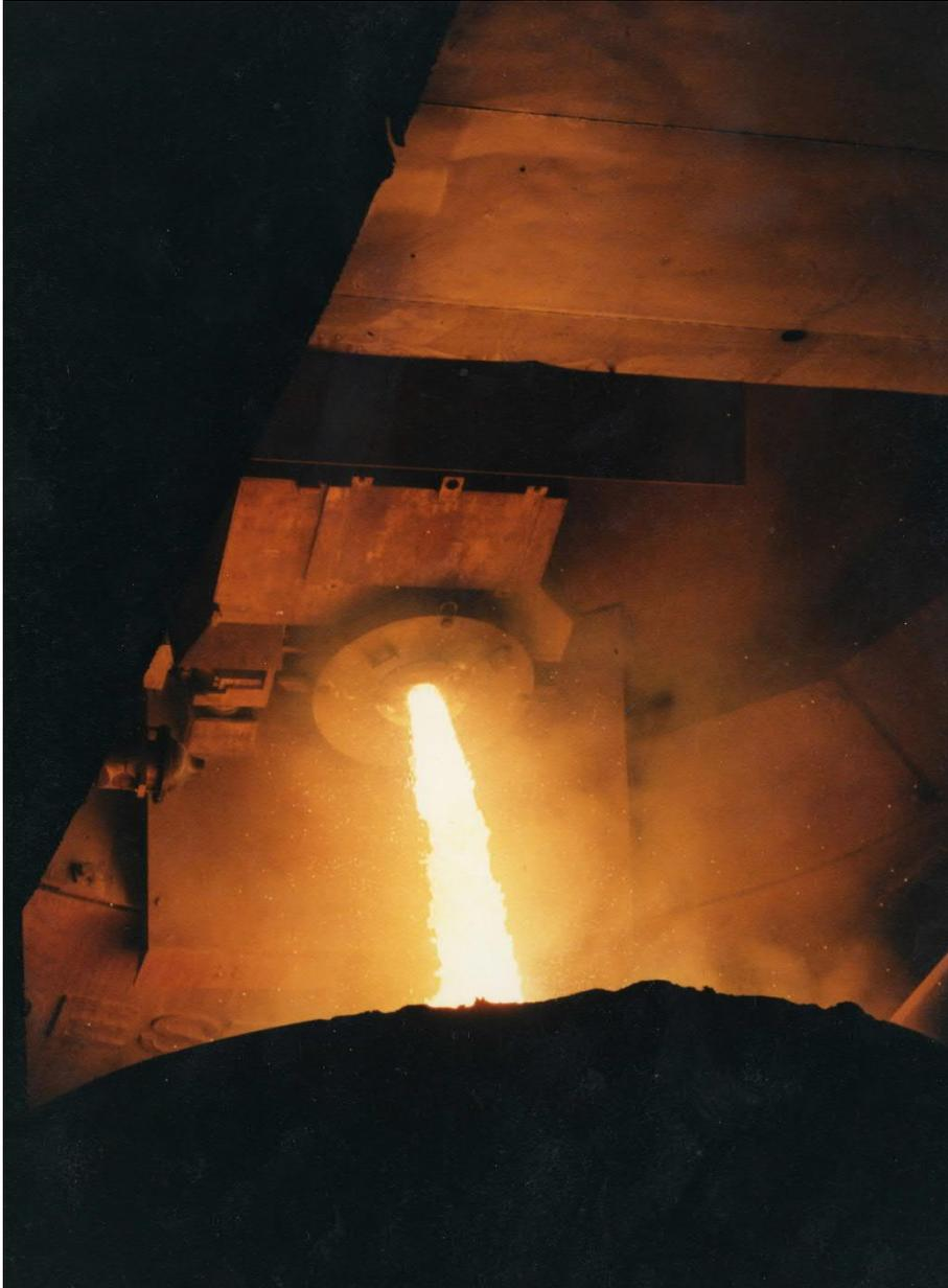
Vazamento de um convertedor BOF. O novo sistema de Vazamento Automatizado desenvolvido pela Primetals Technologies aumenta a produtividade e a segurança do trabalho. A primeira implementação deste sistema em escala industrial será feita na usina de Zhangjiagang da Jiangsu Shagang.
