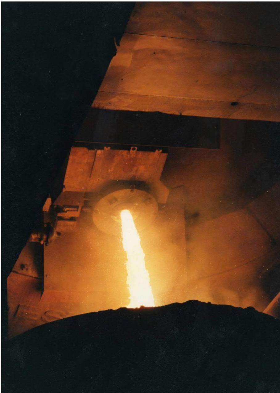
Выпуск плавки из кислородного конвертера. Недавно разработанная система автоматизированного выпуска плавки от Primetals Technologies повышает производительность и безопасность работы. Первое коммерческое применение данной системы на производственной площадке компании Jiangsu Shagang в городе Чжанцзяган.
