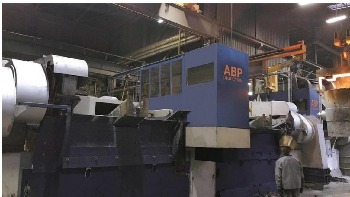
ABP 提供的 IFM 7 Twin Power 系统，能力为 13.4 吨，额定功率为 6 兆瓦(照片由 ABP 提供)
