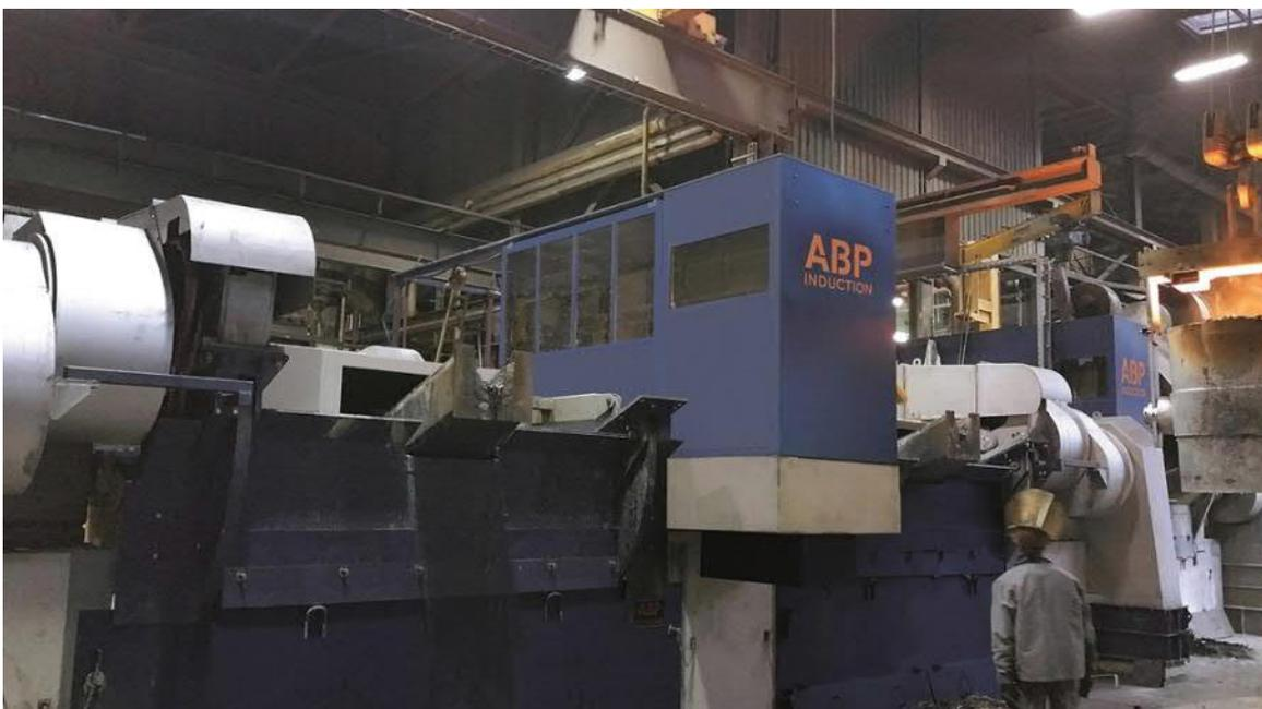
IFM 7 Twin Power von ABP, Kapazität 13,4 Tonnen, Bemessungsleistung 6 MW (Photo: ABP)
