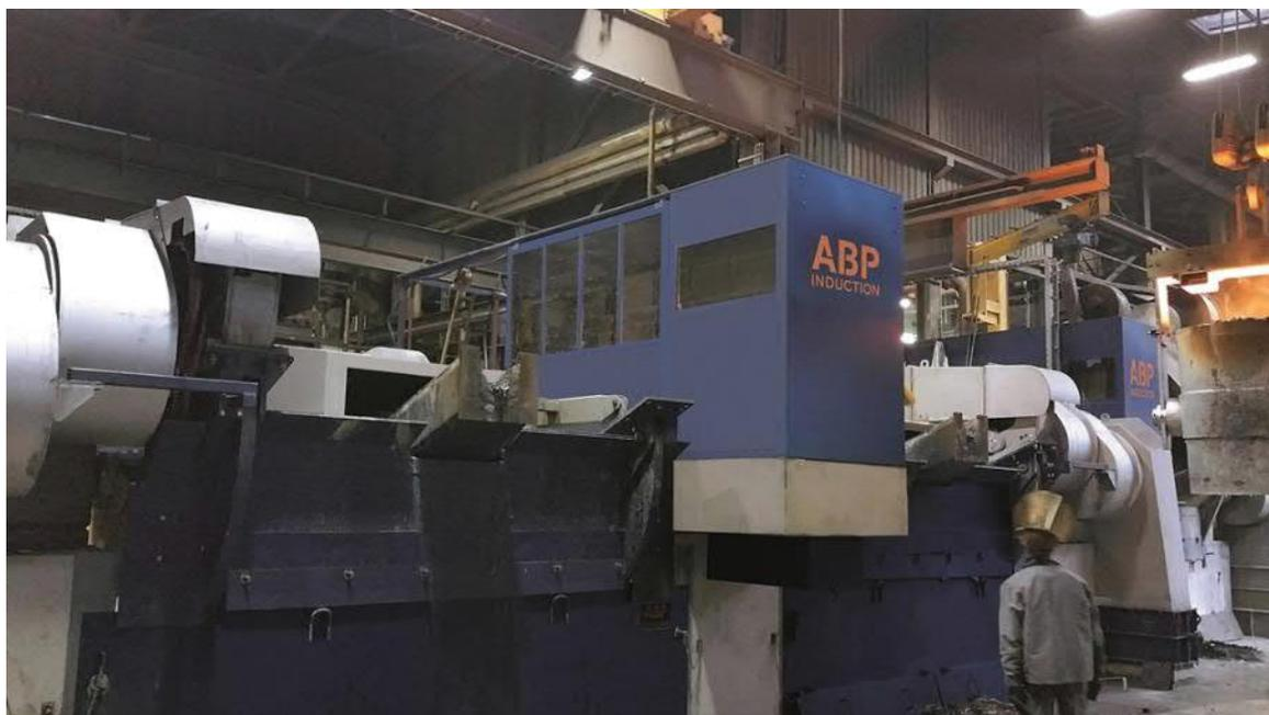
ABP 製 IFM7 ツインパワー（容量 13.4 トン、定格 6MW） 画像提供:ABP
