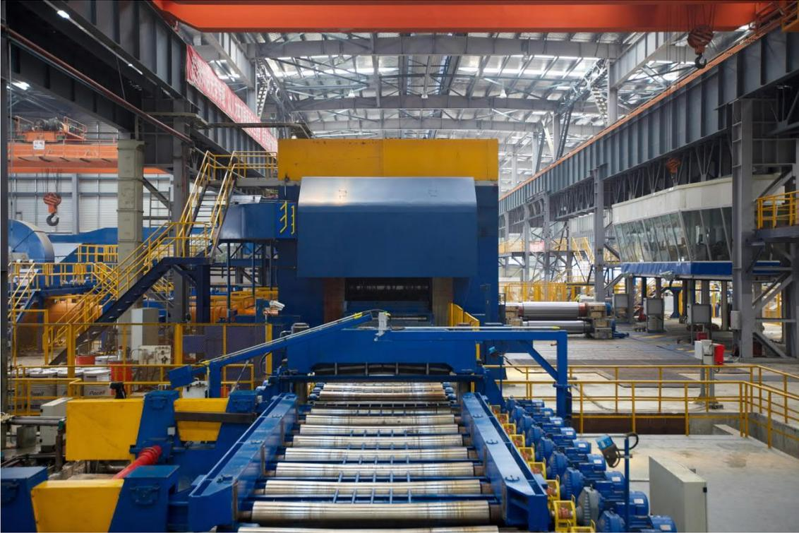
Dreigerüstiges Aluminiumwalzwerk von Primetals Technologies
