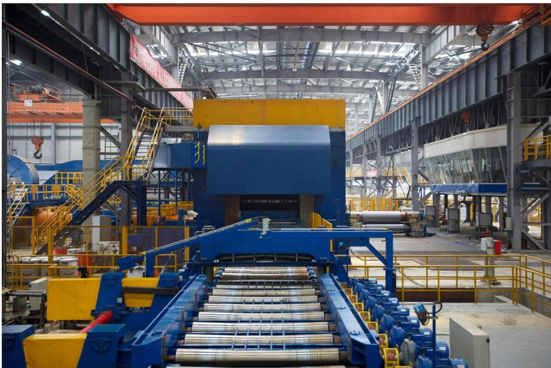
Трехклетьеовой стан горячей прокатки алюминия от Primetals Technologies
