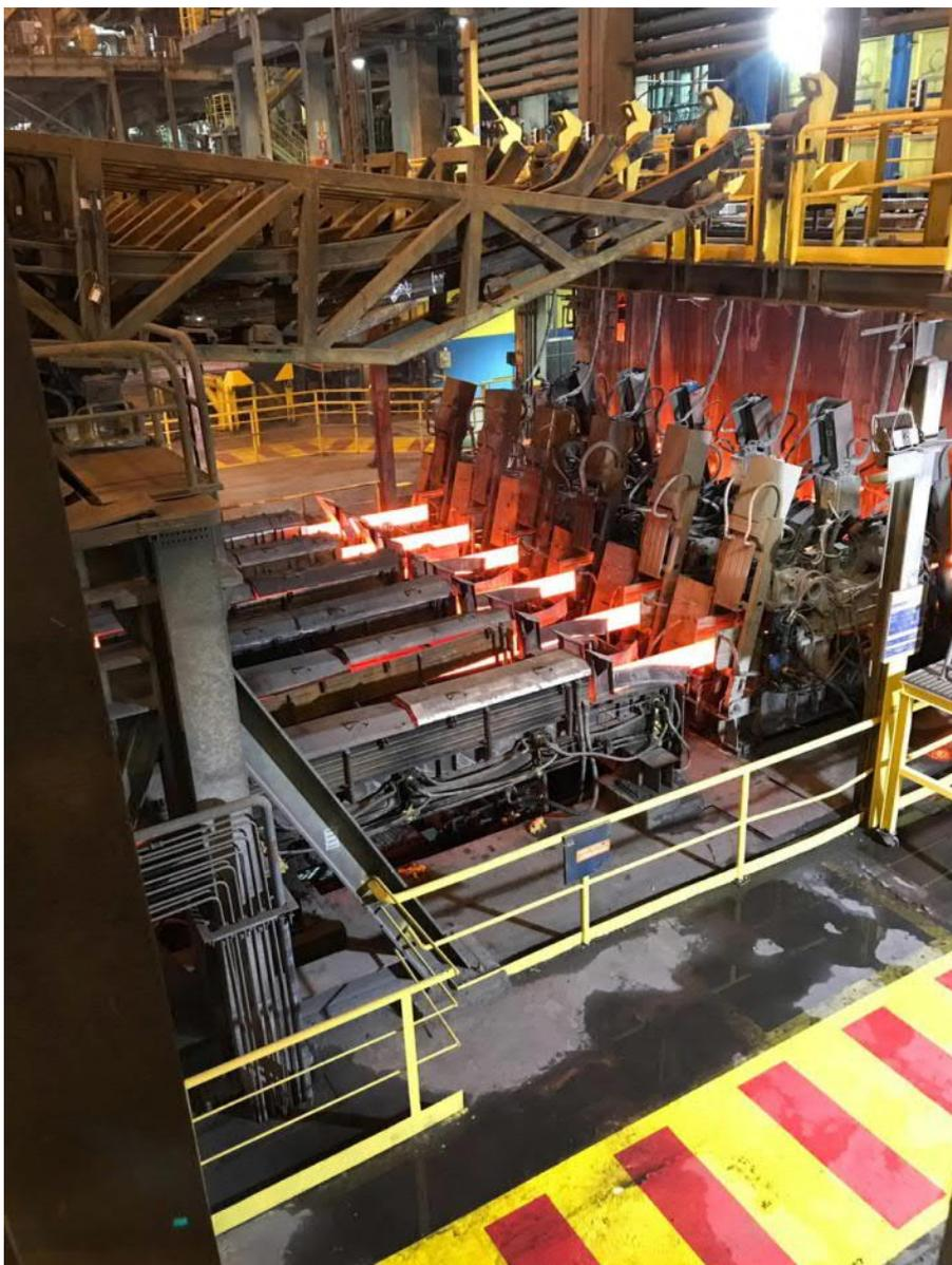
Die neuen Level-1- und Level-2-Systeme von Primetals Technologies für die Stranggießanlage von Gerdau Ouro Branco in Brasilien verbessern die Qualität, verringern den Instandhaltungsaufwand und die Betriebskosten.
