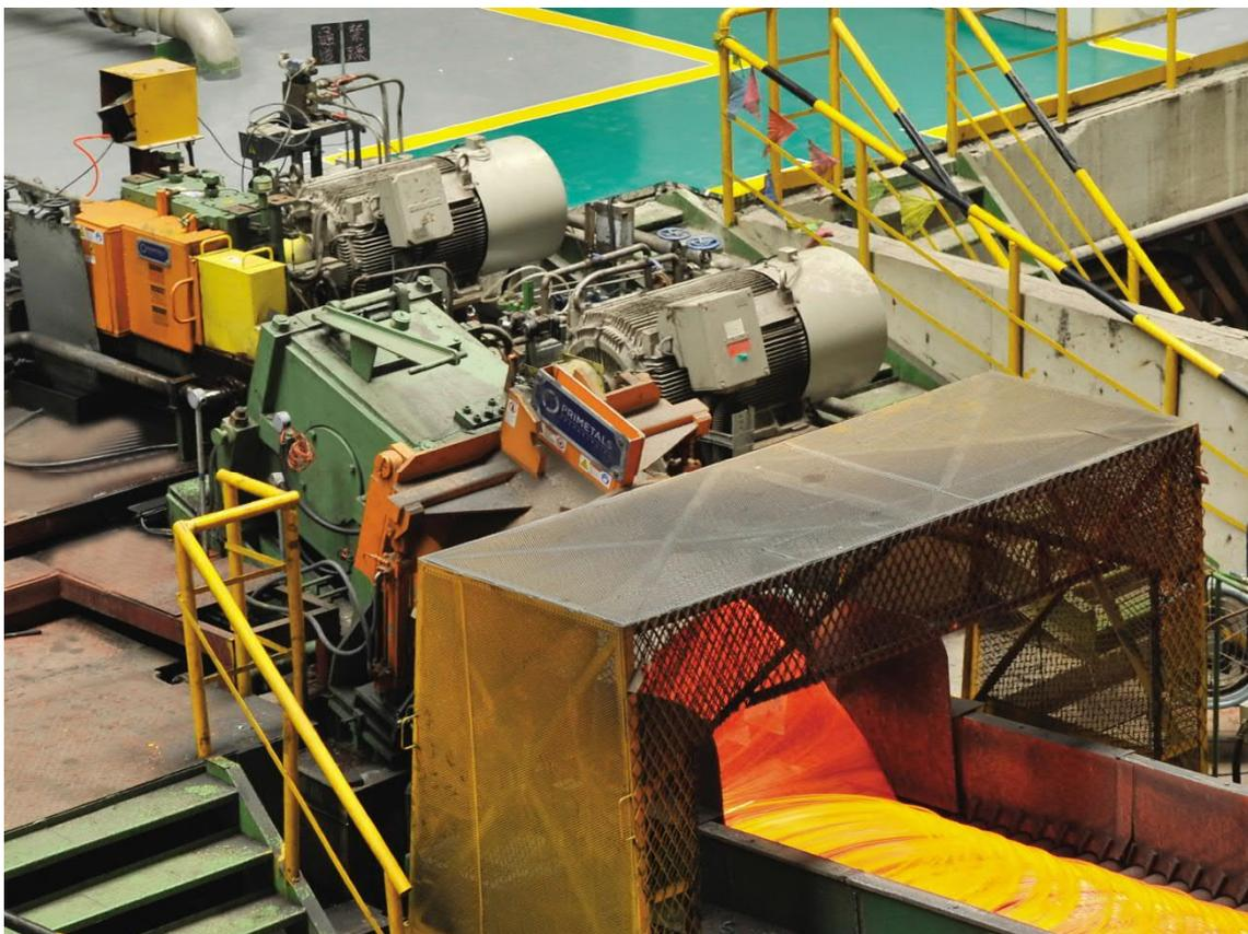
Formador de espiras de alta velocidade Morgan e transportador de resfriamento Morgan Stelmor na saída de fio-máquina.
