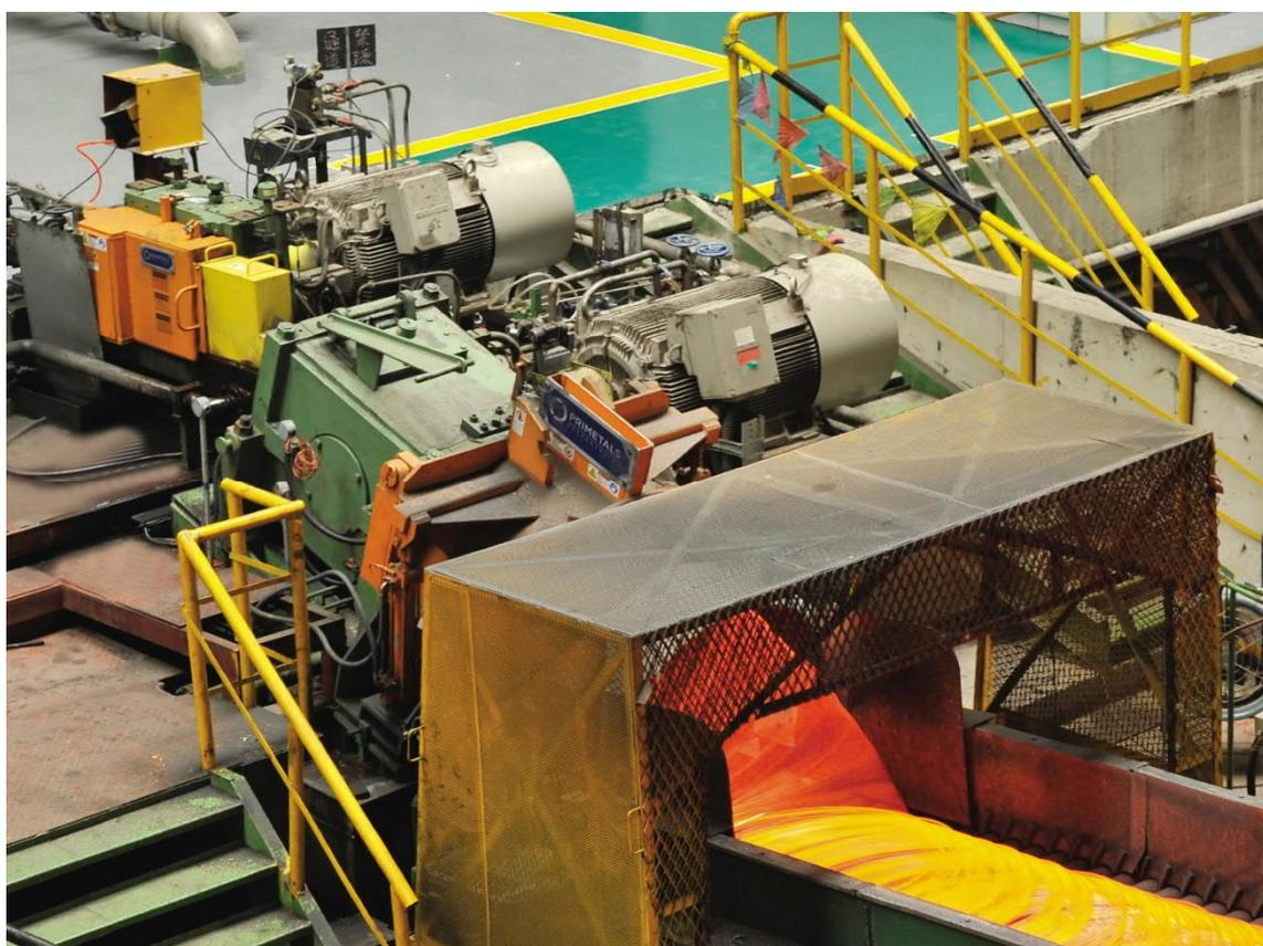
Высокоскоростной виткоукладчик Morgan и охлаждающий конвейер Morgan Stelmor в секции для производства катанки.
