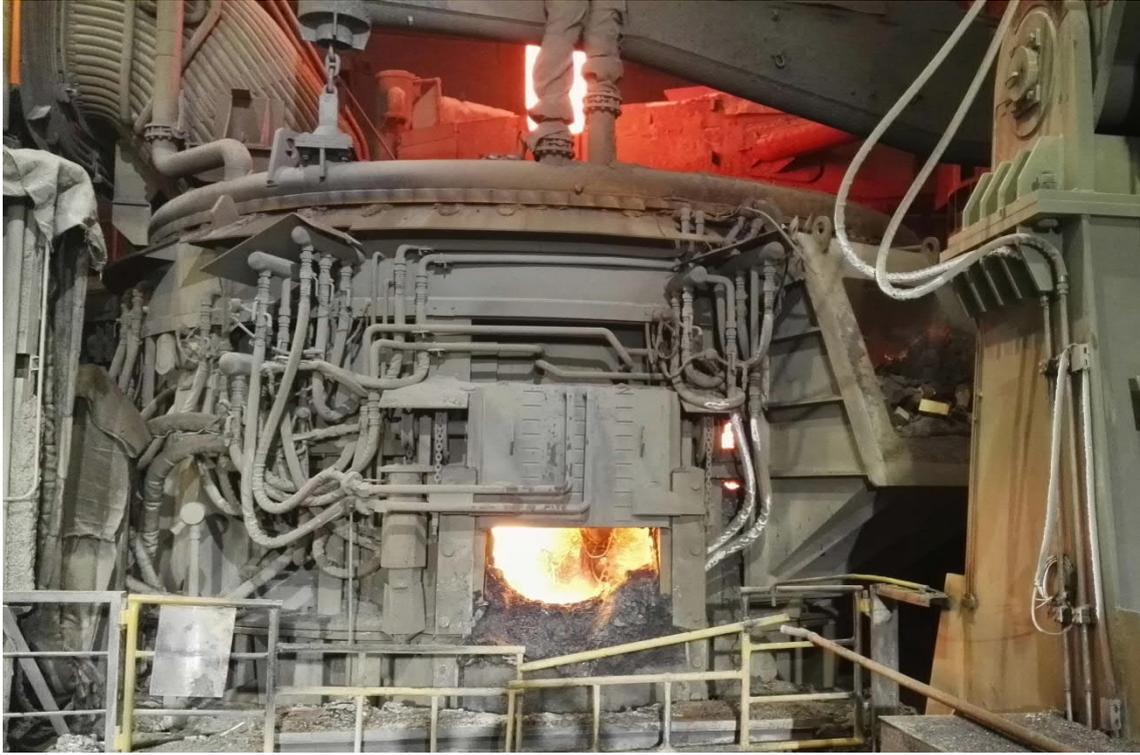
中国上海宝钢的 150 吨双工位电弧炉。
