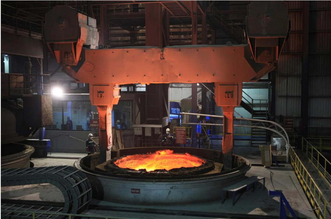
Im Stahlwerk Dilovası des türkischen Stahlherstellers Çolakoğlu Metalurji A.S. (Çolakoğlu) modernisiert Primetals Technologies eine bestehende VD-Anlage (Anlage zur Vakuumentgasung), um sie in eine VOD-Anlage (Anlage zur Vakuum-Sauerstoff-Entkohlung) umzuwandeln.
