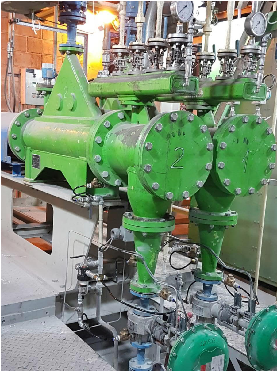
以 3 – 15 kg/min 流量精确加镁的体积计量式加料装置
