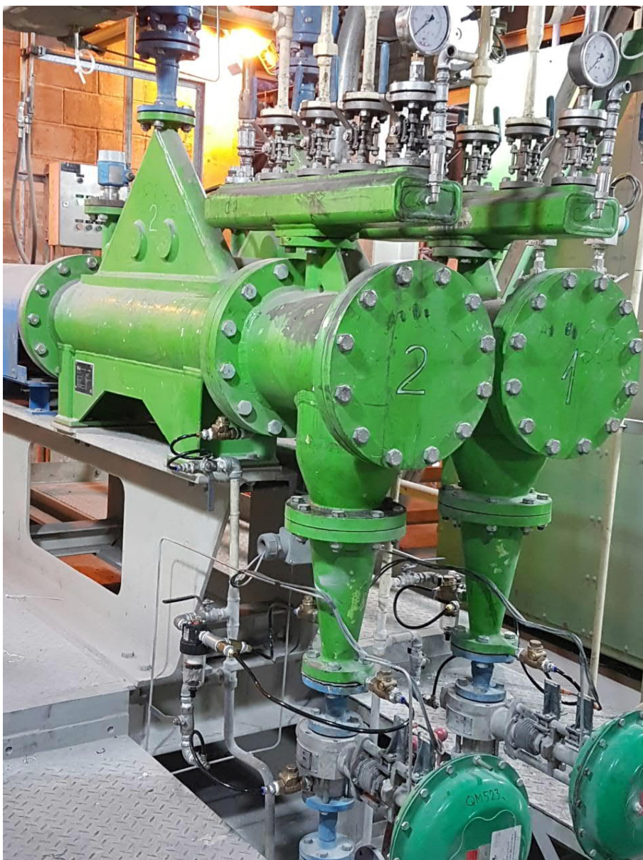
Volumetrische Dosieranlage zur präzisen Mg-Injektion mit Förderraten zwischen 3 und 15 kg/min
