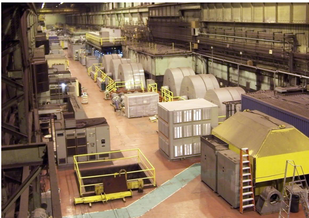
Halle mit Fertigstraßenmotoren bei California Steel in Fontana, Kalifornien
