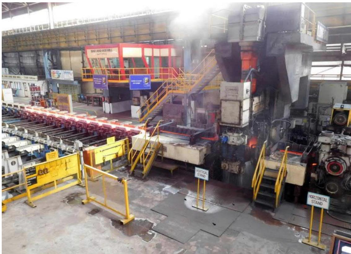
Modernisiertes Walzwerk mit neuer reversierender Vorwalzgruppe von Primetals Technologies bei JSW Steel Ltd. in Salem, Indien
