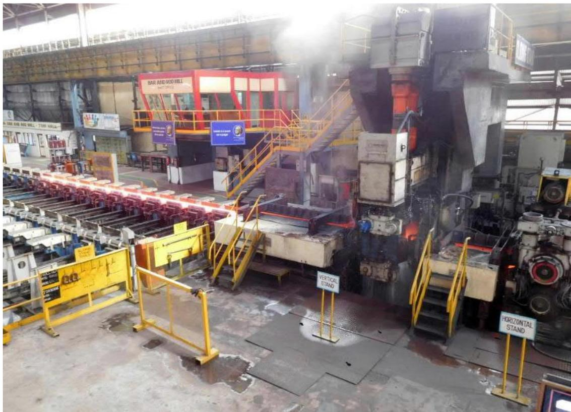
Nuovo gruppo sbozzatore reversibile di Primetals Technologies nel laminatoio ammodernato di JSW Steel Ltd. a Salem, India.
