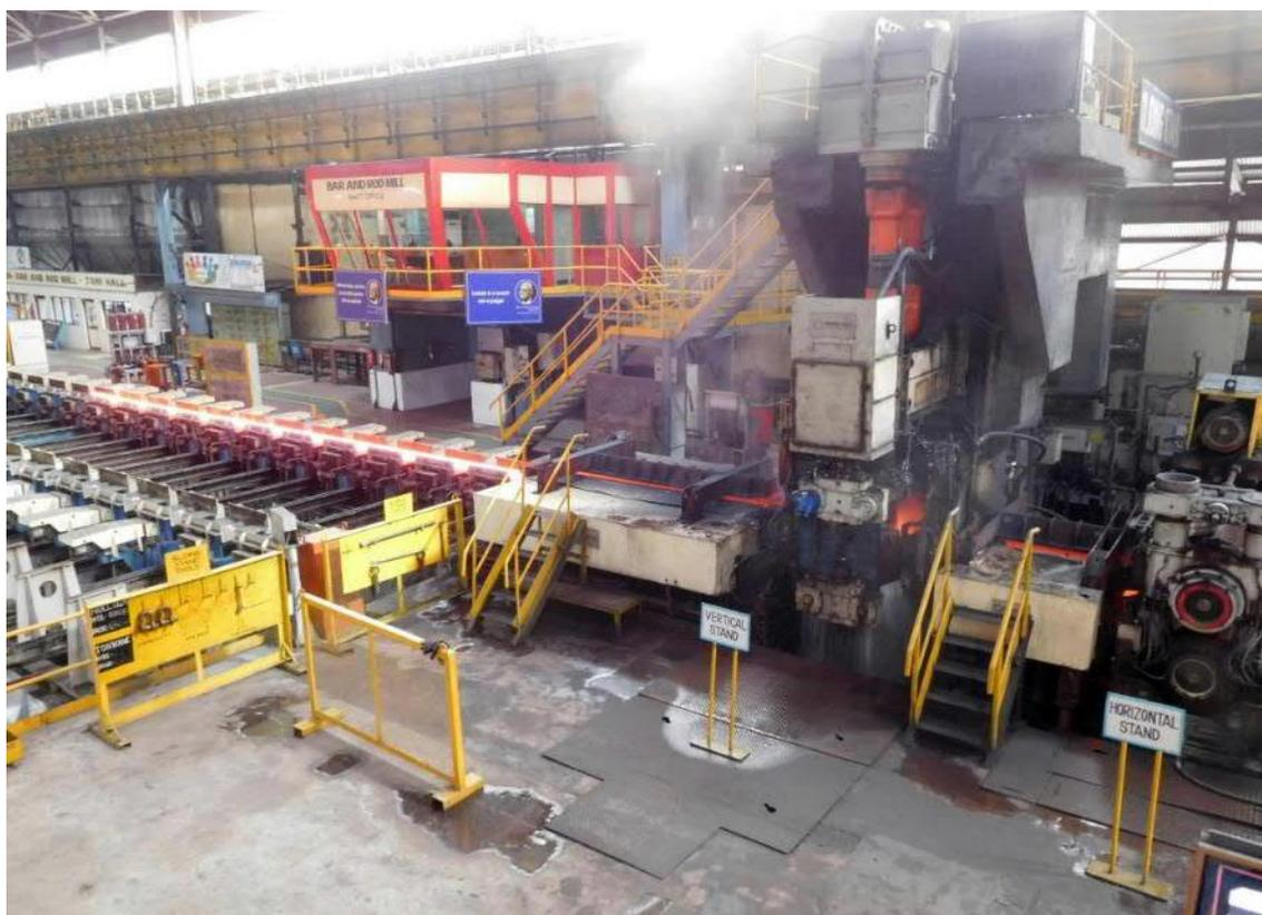
Laminador modernizado com novo grupo desbastador reversível da JSW Steel Ltd. em Salem, Índia, fornecido pela Primetals Technologies.
