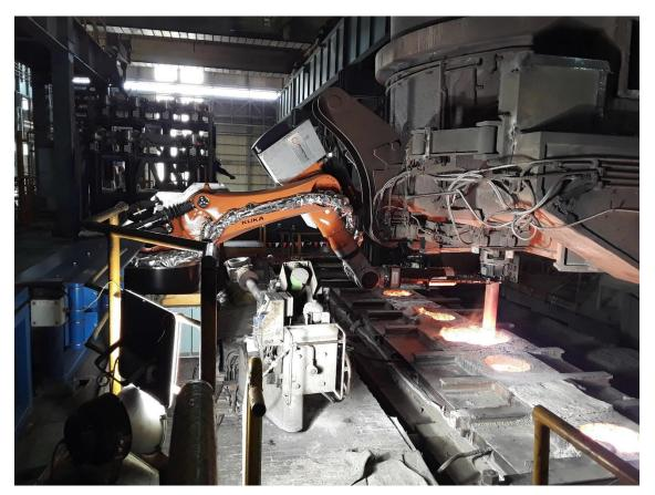
宝钢梅山 4号连铸机上的 LiquiRob 正在拆下长水口。
