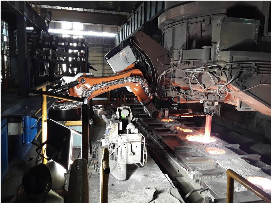
LiquiRob an der Anlage CCM4 von Baosteel Meishan beim Entfernen eines Schattenrohrs
