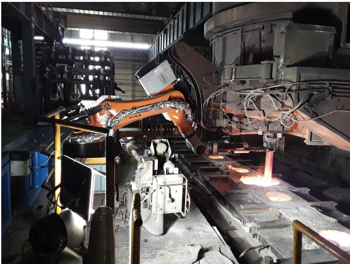
宝山鋼鉄梅山製鉄所の CCM4 に設置されたリキロボシステム（シュラウドの取り外し中）
