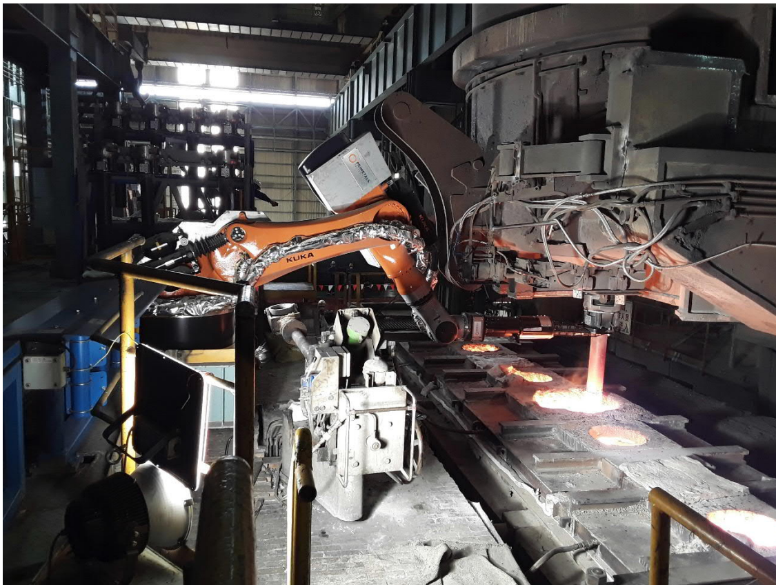
LiquiRob отсоединяет защитную трубу на МНЛЗ № 4 на заводе Baosteel в Мэйшане
