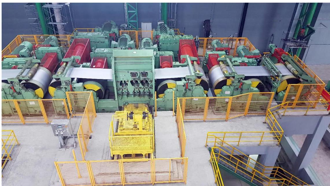
Linha de decapagem contínua (CPL) fornecida pela Primetals Technologies para a nova usina da siderúrgica chinesa Shougang Jingtang United Iron & Steel Co., Ltd. (Shougang Jingtang) em Caofeidian.
