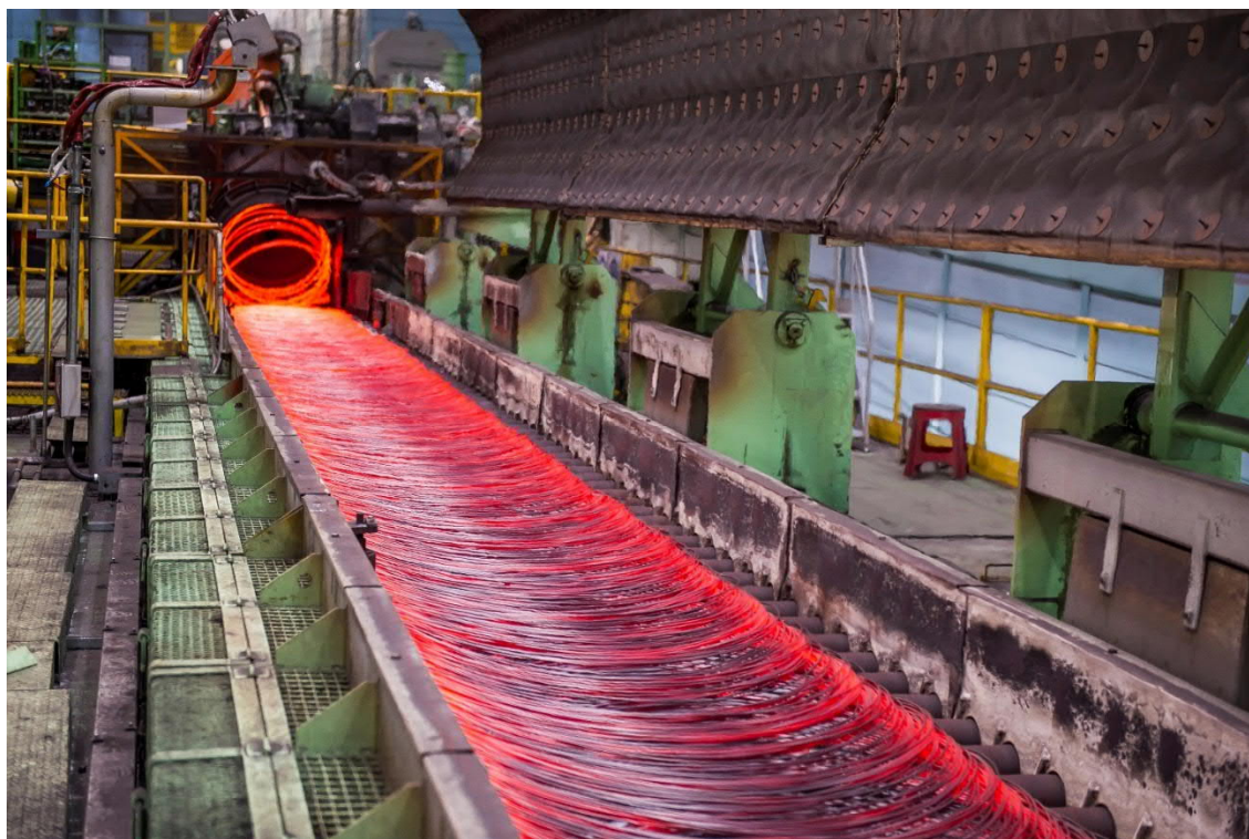
Morgan-Stelmor-Kühlband von Primetals Technologies in Betrieb während der Produktion.
