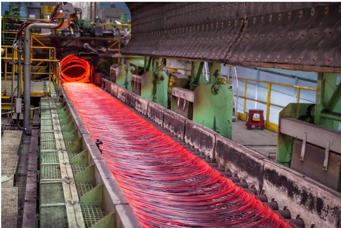
稼働中のプライメタルズテクノロジーズ製のモルガン・ステルモア・コンベヤー
